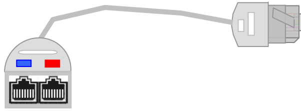
图 2-16 RJ48C 一转二示意图
