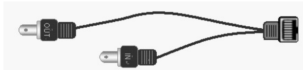
图 2-17 RJ48C 接口与 BNC 接口的转换
